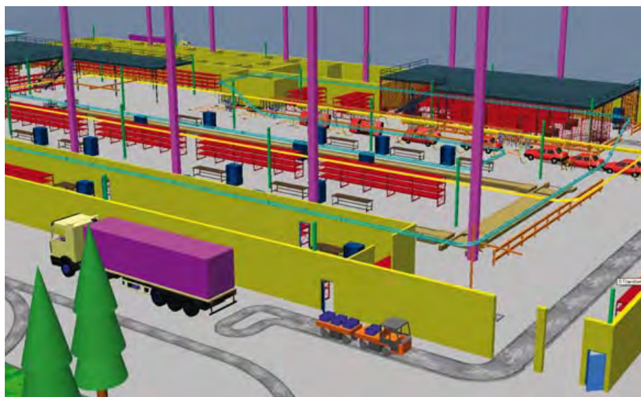
Simulation von Fertigungsprozessen – mit Plant Simulation erreichte Behr die Reduzierung des Work-in-Progress von 2000 auf 700 Teile
