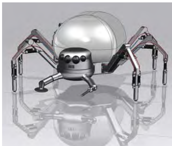
Philodromidae (Laufspinne) Dieser Roboter ist sowohl mit Spinnenbeinen als auch mit einem Radantrieb verfügbar.
